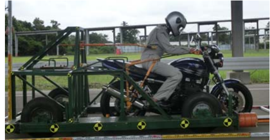
図2.5 衝突実験で使用するバイク
